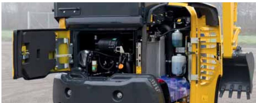
Achterkleppen voor een snelle motorcontrole, gemakkelijke controle en reiniging van de radiatoren en een snelle toegang tot de accu
