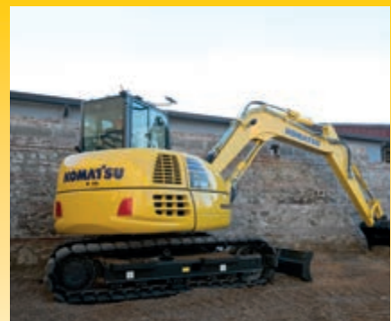
Door een kleinere zwenkradius voor en een zwenkfunctie voor de giek is het graven van sleuven een makkie
