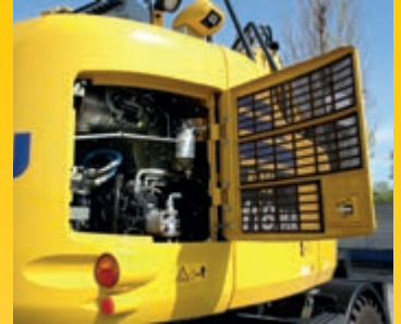
Alle belangrijke onderhoudspunten zijn goed bereikbaar vanaf de grond
