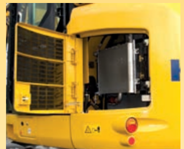
De radiatorrozetten zijn in de zijdeuren geïntegreerd, zodat ze vanaf de grond makkelijk bereikbaar zijn voor reiniging
