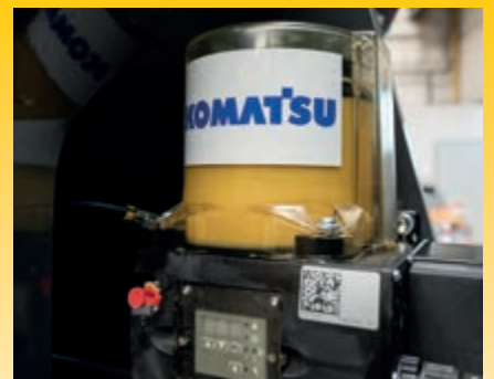
Het in de fabriek gemonteerde automatische smeersysteem beperkt het dagelijkse onderhoudswerk tot een minimum (optie)
