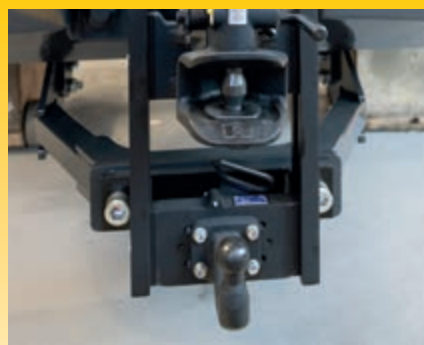
In hoogte verstelbare, kogelvormige en automatische trekhaken (optie)
