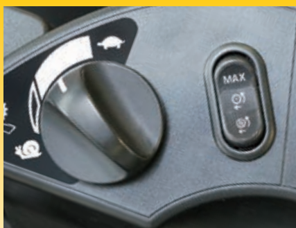
Bedieningsknop voor de variabele afstelling met het nieuwe kruipsnelheidsbereik (links) en schakelaar voor het variabele traction control system (rechts)
