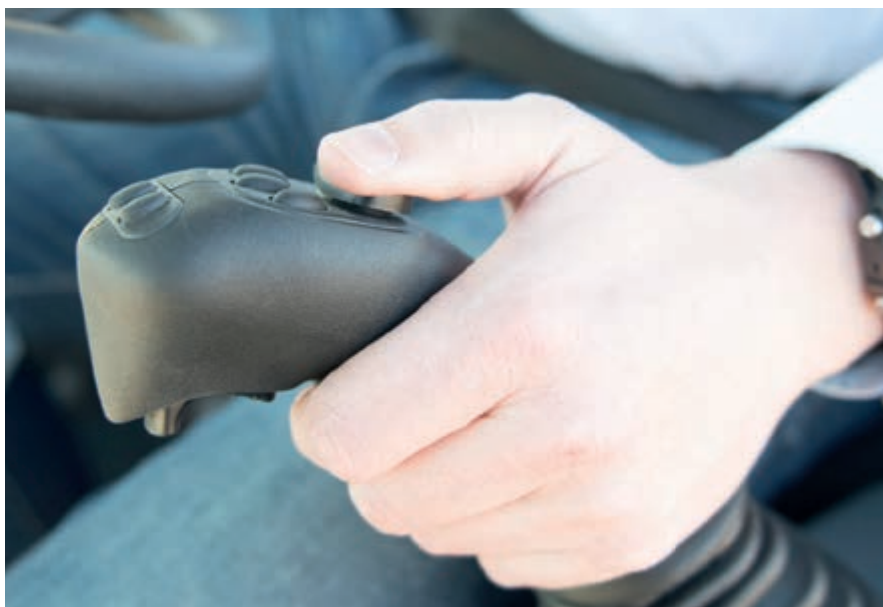
Dankzij de bediening via regelbare joysticks vereist de bediening van de machine minder inspanning, zelfs bij stuurintensieve werkzaamheden
