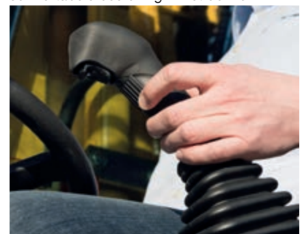
Dankzij de bediening via regelbare joysticks vereist de bediening van de machine minder inspanning, zelfs bij stuurintensieve werkzaamheden
