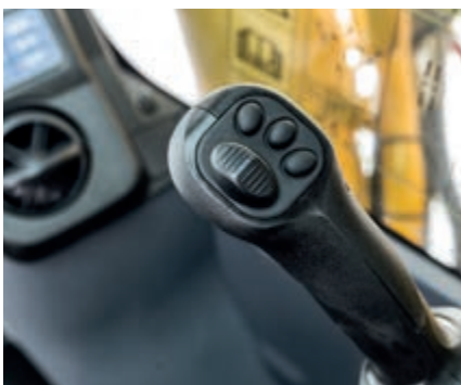
Praktische, ergonomische en precieze bediening dankzij de joysticks met proportionele controleknop voor de hulpstukken
