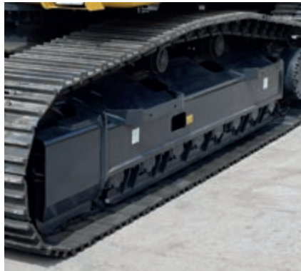
Onderrolbescherming over de volledige rups lengte (optie)
